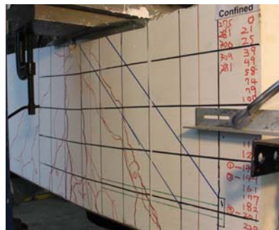
圖14 CCT節點試體之Flexure Failure圖
