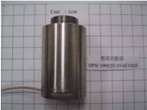
Figure 4. Piezoelectric actuator.
